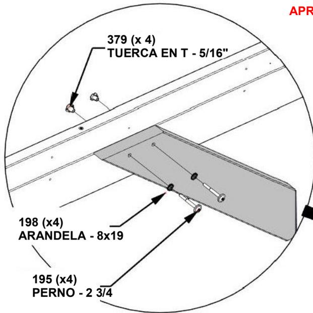
**INSERTE LAS TUERCAS EN T EN EL MONTAJE DE LA VIGUETA PRIMERO**
