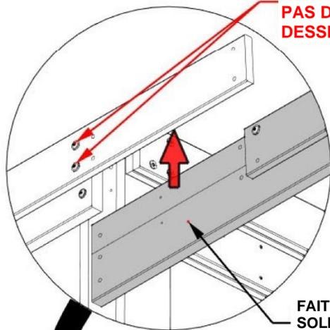
FAITES GLISSER L'ASSEMBLAGE DE SOLIVE DERRIÈRE L'ASSEMBLAGE DE SOLIVE EXISTANT
