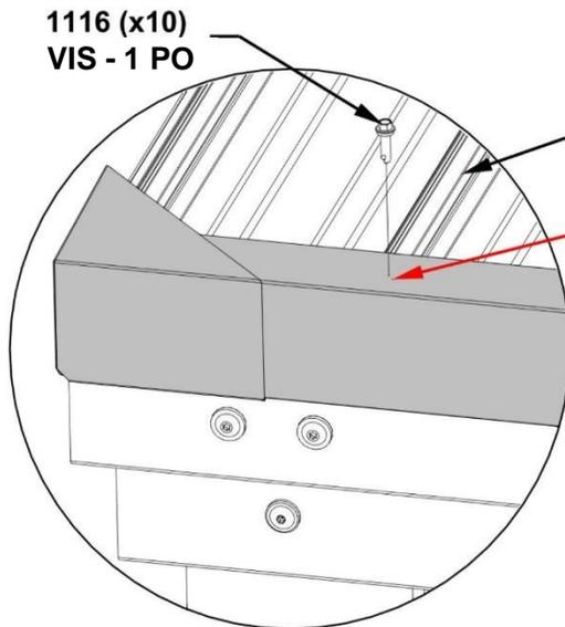
**FIXEZ CETTE VIS À TRAVERS LA GARNITURE ET DANS LA 2ÈME FAÎTE DE LA TÔLE. SAUTEZ UNE TÔLE. ET RÉPÉTEZ L'OPÉRATION.**
