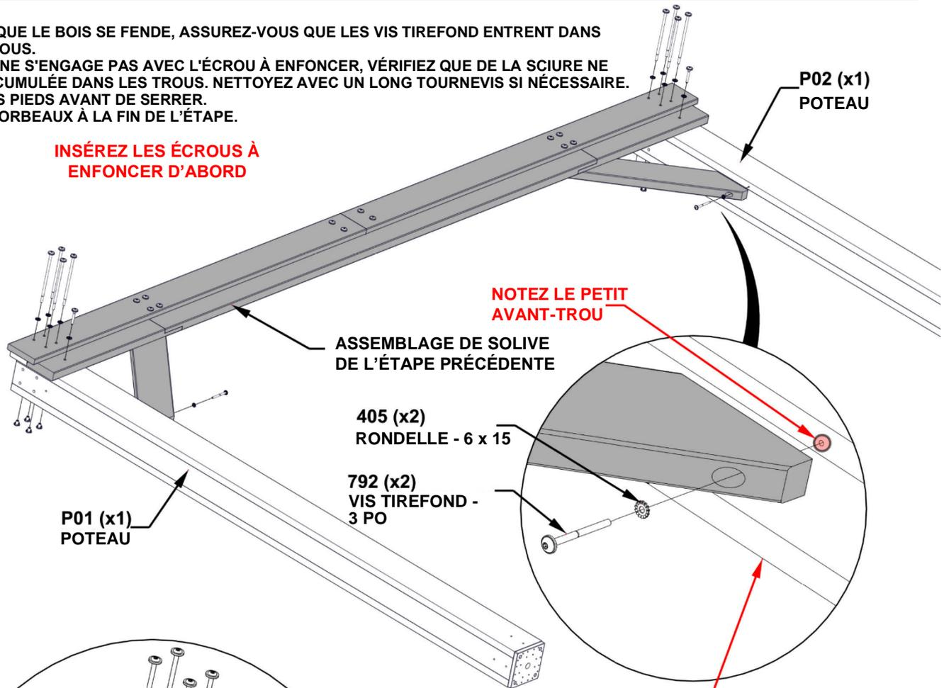
**ORIENTEZ LE POTEAU DE FAÇON À CE QUE LE DEUXIÈME AVANT-TRou SOIT POSITIONNÉ DE CE CÔTÉ DES POTEAUX.**
