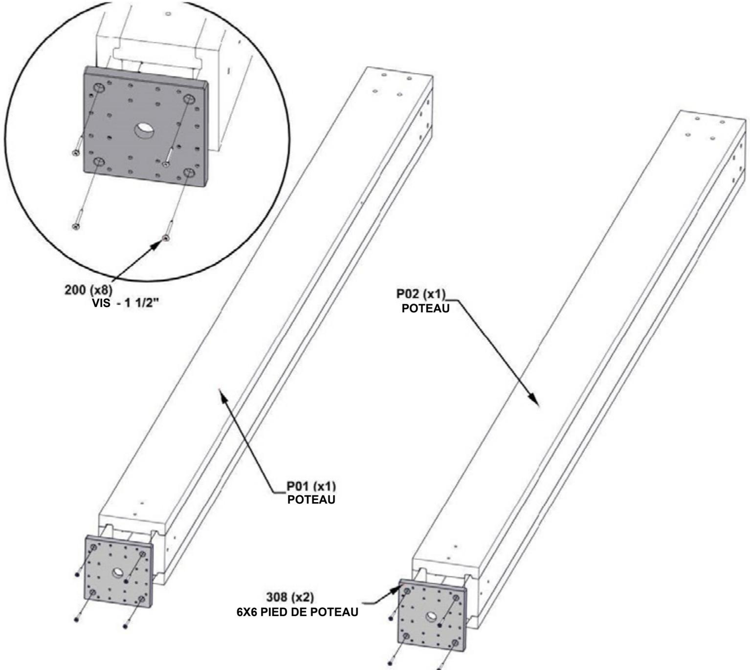
**ALIGNER LE PIED DE POSTE ET LA PERCEUSE 1/8" [3mm] TROUS PILOTES POUR LE MATÉRIEL DE FIXATION.**
