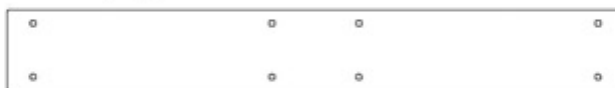
G1 | SOPORTE DE LA VIGA DEL COLUMPIO - W4L14542 (x1) | 1" x 5 1/4" x 40 3/8" (24 x 134 x 1024)
