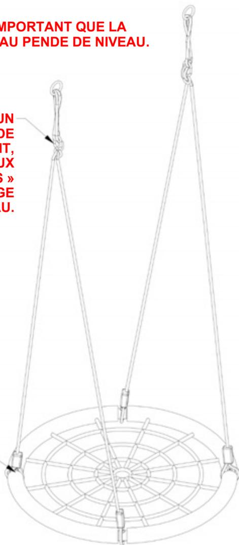
**LA BALANÇOIRE DOIT ÊTRE RÉGLÉE À UN MINIMUM DE 8 POUCHES (20 CM) DU SOL LORSQU'ELLE EST INSTALLÉE.**
