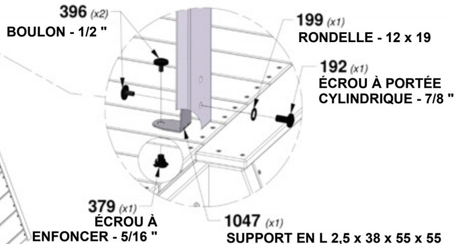
**EN UTILISANT LES SUPPORTS COMME GUIDE, PERCEZ (1) TROU DE 3/8" [10 mm] À TRAVERS LE PLANCHER POUR LA QUINCAILLERIE.**
