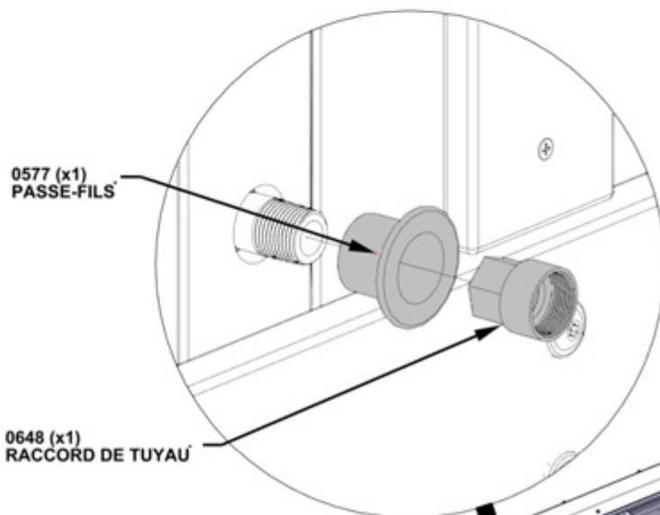
**INSTALLEZ LE PASSE-FILS DE CAOUTCHOUC AVANT DU RACCORD DE TUYAU DE FILET**
