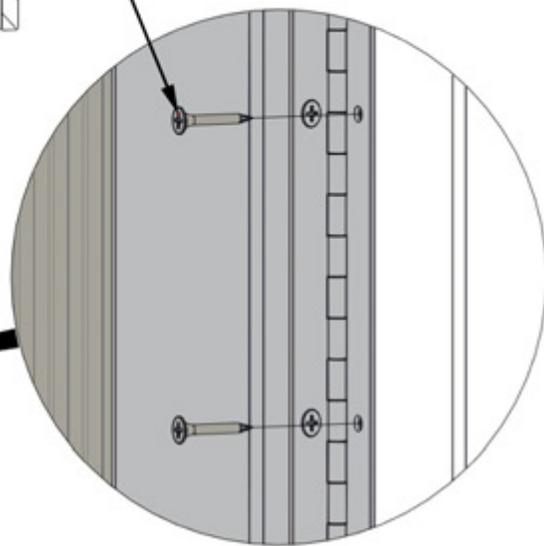
ATTACHEZ L'ASSEMBLAGE DE FENÊTRE EN UTILISANT LES TROUS PILOTES DANS LE POTEAU COMME MONTRÉ
