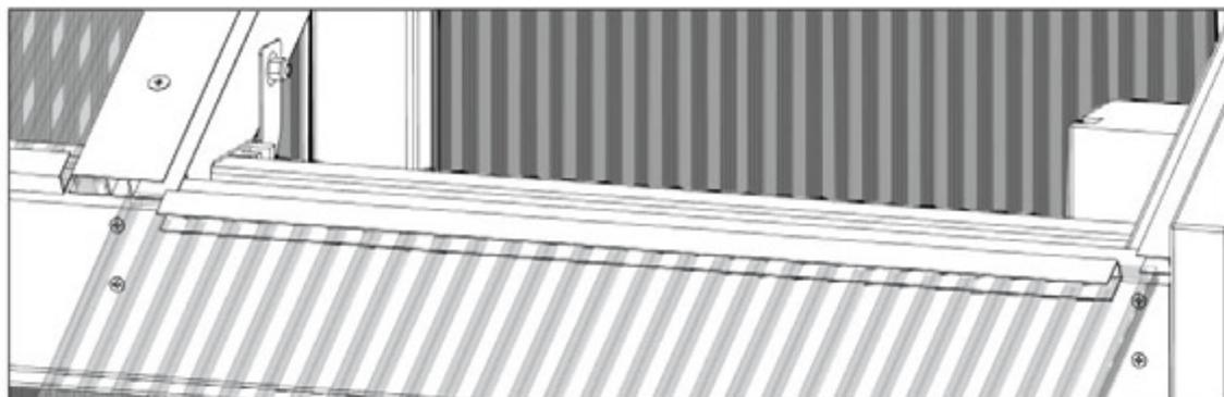
S'IL Y A BESOIN VEUILLEZ DESSERRER LES VIS SUR LA JOINTURE DU FEUILLE POLY
