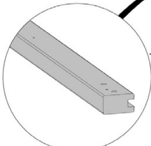
**NOTEZ L'EMPLACEMENT DES CREUX ET LES TROUS PILOTES POUR L'ORIENTATION CORRECTE. IL EST CRUCIAL POUR LES ÉTAPES SUIVANTES**
