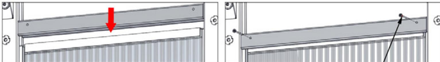
GLISSEZ LE CREUX DE BOUCHON DE FENÊTRE SUR L'ASSEMBLAGE ET VISSER EN PLACE
