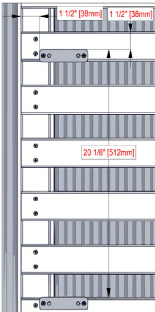
**ATTACHEZ LES SUPPORTS EN UTILISANT LES DIMENSIONS INDIQUÉES**
