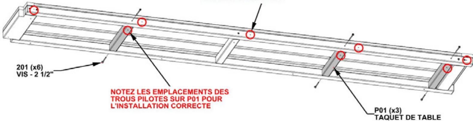
DEUXIÈMEMENT, INSTALLER LES VIS À TRAVERS LES TROUS PILOTES SUR LE DOSSIER DE LA TABLE DANS LES CALES DE LA TABLE COMME INDIQUÉ.
