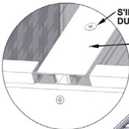
S'IL Y A BESOIN VEUILLEZ DESSERRER LES VIS SUR LA JOINTURE DU FEUILLE POLY
