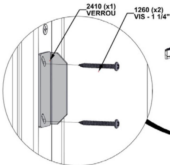
ATTACHEZ EN UTILISANT LES TROUS PILOTES
