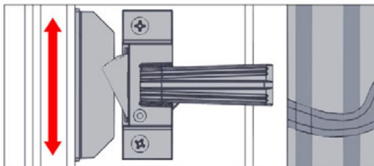
**AVEC LA PORTE FERMÉE POSITIONNER LE VERROU DE PORTE COMME MONTRÉ. AJUSTEZ DE L'AVANT À L'ARRIÈRE POUR S'ASSURER QUE LE VERROU FASSE CONTACT AVEC LA POIGNÉE. AJUSTEZ DE HAUT EN BAS POUR VÉRIFIER QUE LE VERROU EST CENTRÉ AVEC LA POIGNÉE. MARQUEZ LES EMPLACEMENTS DU TROU FENDU ET FOREZ UN TROU AVEC UNE MÈCHE DE 3MM**
