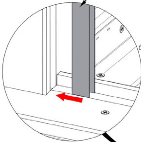
**- INSÉRER LE CANAL POLY DANS LA RAINURE À PARTIR DU REBORD DE LA FENÊTRE ET REMONTER.**
