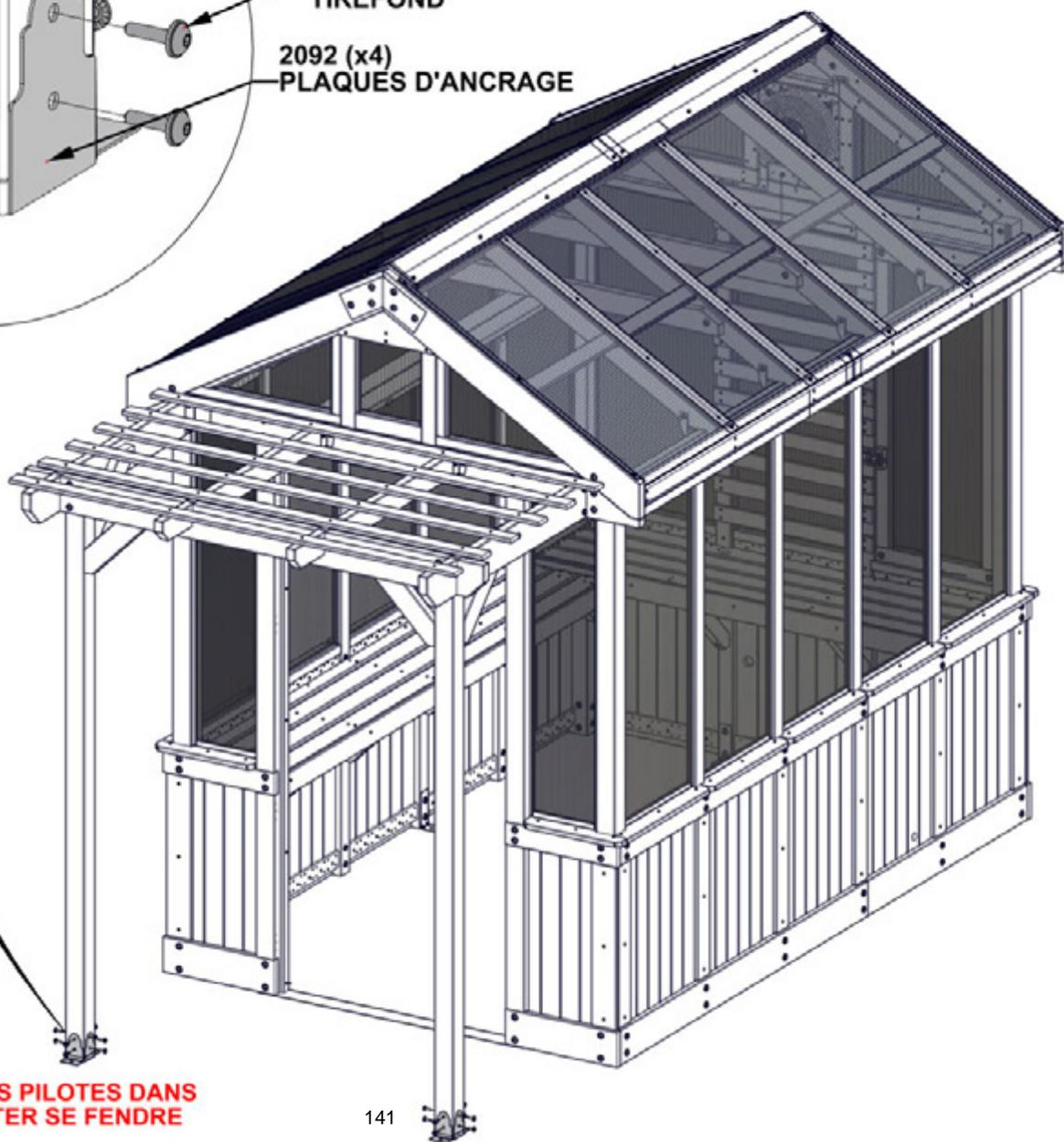
**ALIGNER AVEC LES TROUS PILOTES DANS LES POTEAUX AFIN D'ÉVITER SE FENDRE LE BOIS**
