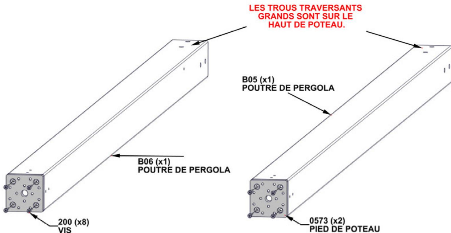
**ALIGNEZ LE PIED DE POTEAU ET FORER LES TROUS PILOTES DE 3MM POUR L'ATTACHEMENT DE QUINCAILLERIE.**
