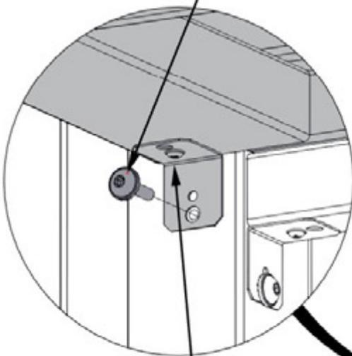
**DÈS QUE LES TIREFONDS SONT ATTACHÉS, SERREZ LES VIS SUR LES SUPPORTS AU MAXIMUM**
