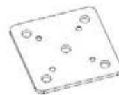
P02 PIED DE POTEAU -A4M02182 (x1) 1/4"x5 1/2"x5 1/2" (6x139x139)
