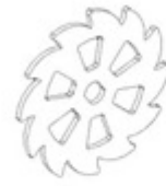
S02 SPROCKET - A4M02147 (x1) 3/16"x4 11/16"x4 11/16" (4x119x119)
