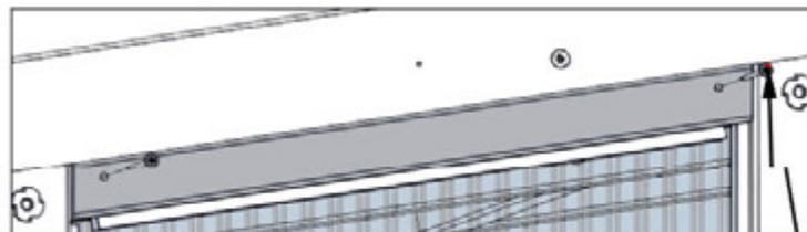
GLISSEZ LA CREUX DANS LE CAPUCHON SUR L'ASSEMBLAGE DE FENÊTRE ET VISSER EN PLACE.
