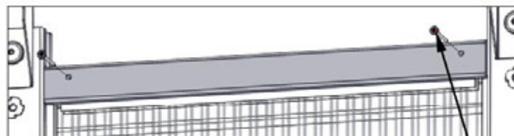
GLISSEZ LA CREUX DANS LE CAPUCHON SUR L'ASSEMBLAGE DE FENÊTRE ET VISSER EN PLACE.
