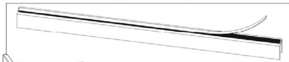
**- INSEREZ LE CANAL POLY DANS LE CREUX DU REBORD DE FENÊTRE ET TRAVAILLER VERS LE HAUT**
