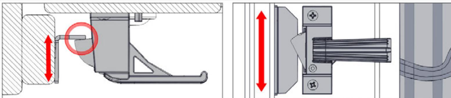
**AVEC LA PORTE FERMÉE POSITIONNER LE VERROU DE PORTE COMME MONTRÉ, AJUSTEZ DE L'AVANT À L'ARRIÈRE POUR S'ASSURER QUE LE VERROU FASSE CONTACT AVEC LA POIGNÉE. AJUSTEZ DE HAUT EN BAS POUR VÉRIFIER QUE LE VERROU EST CENTRÉ AVEC LA POIGNÉE, MARQUEZ LES EMPLACEMENTS DU TROU FENDU ET FOREZ UN TROU AVEC UNE MÈCHE DE 3MM**
