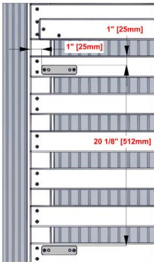
**ATTACHEZ LES SUPPORTS EN UTILISANT LES DIMENSIONS INDIQUÉES**
