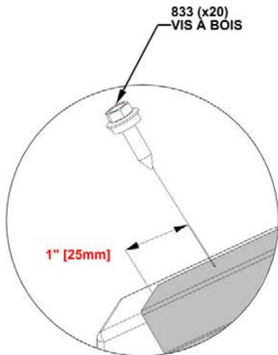
INSTALLEZ LES VIS DANS LE CENTRE DE LA GARNITURE ENVIRON À 25MM AUX BORDS COMME MONTRÉ. INSTALLEZ UN AUTRE VIS ENTRE LES DEUX VIS EXTÉRIEURES
