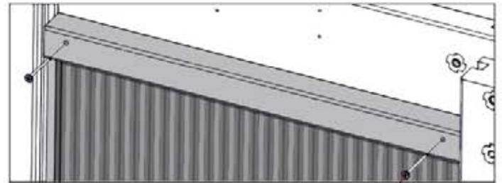
GLISSEZ LE CAPUCHON DE FENÊTRE SUR L'ASSEMBLAGE DE FENÊTRE PUIS LE VISSER EN PLACE
