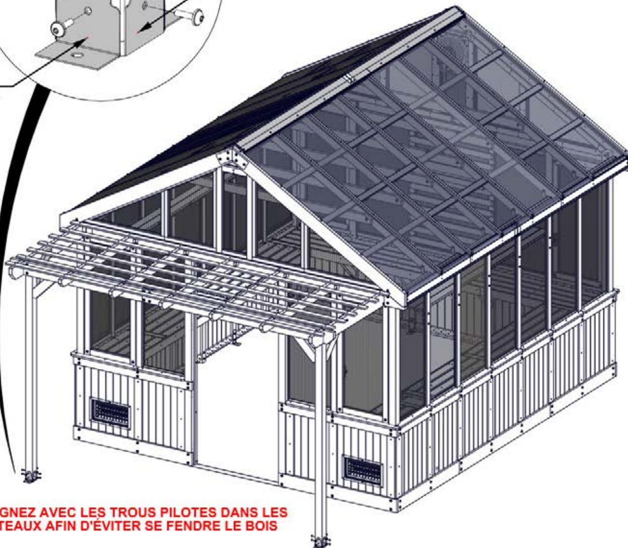
**ALIGNER AVEC LES TROUS PILOTES DANS LES POTEAUX AFIN D'ÉVITER SE FENDRE LE BOIS**
