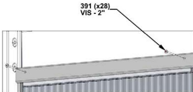
GLISSEZ LE CAPUCHON DE FENÊTRE SUR L'ASSEMBLAGE DE FENÊTRE PUIS LE VISSER EN PLACE.
