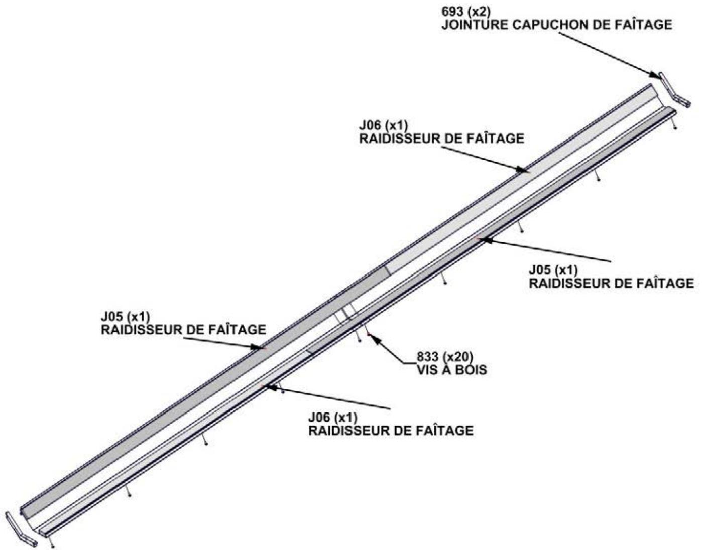
**RETIREZ LES CALES D'ESPACEMENT DU CAPUCHON DE FAÎTAGE AVANT DE L'INSTALLER**
