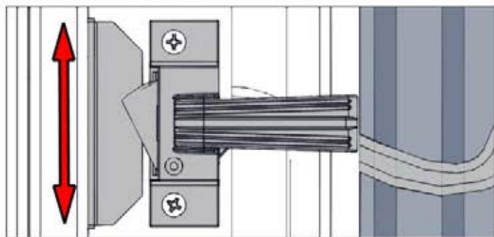
**AVEC LA PORTE FERMÉE POSITIONNER LE VERROU DE PORTE COMME MONTRÉ. AJUSTEZ DE L'AVANT À L'ARRIÈRE POUR S'ASSURER QUE LE VERROU FASSE CONTACT AVEC LA POIGNEE. AJUSTEZ DE HAUT EN BAS POUR VÉRIFIER QUE LE VERROU EST CENTRÉ AVEC LA POIGNEE. MARQUEZ LES EMPLACEMENTS DU TROU FENDU ET FOREZ UN TROU AVEC UNE MÈCHE DE 3MM**
