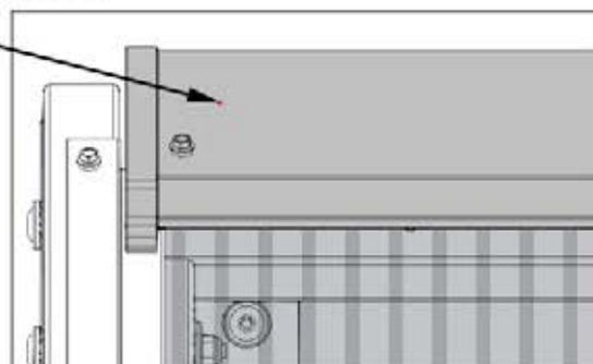
UTILISEZ UN EXTENSEUR DE MÈCHE CRUCIFORME POUR ATTACHER LES VIS
