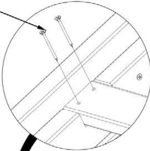
INSÉREZ LES VIS DANS LES TROUS PILOTES
