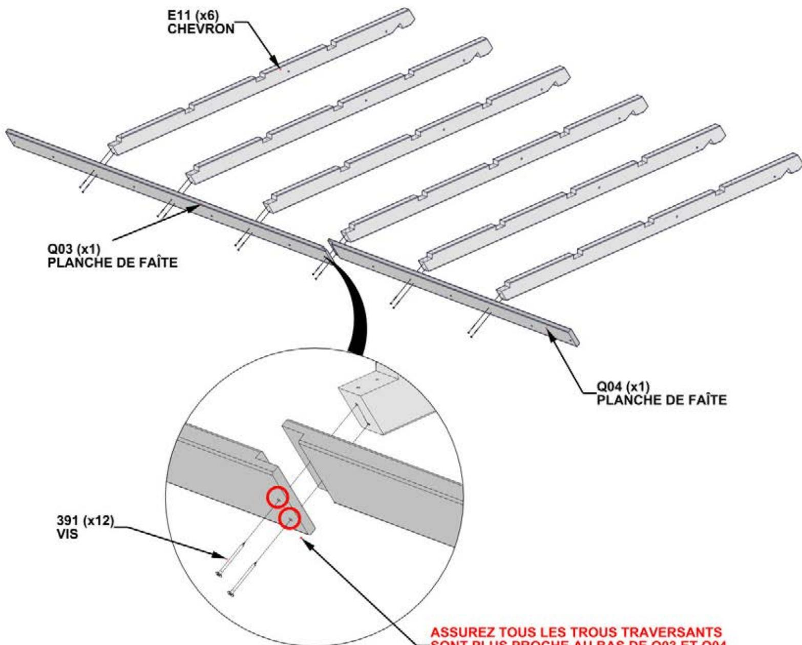
**ASSUREZ TOUS LES TROUS TRAVERSANTS SONT PLUS PROCHE AU BAS DE Q03 ET Q04 POUR L'ORIENTATION CORRECTE**
