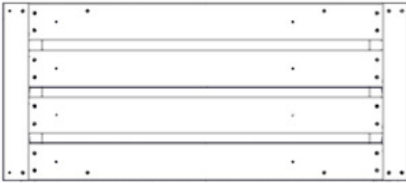
TB04 TABLE ASSEMBLY - W2A04159 (x1) 2 1/16"x16 1/16"x36 9/16" (52x408x929)
