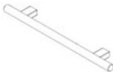
H2 POIGNÉE EN ACIER INOXYDABLE - A4M03024 (x5) 5/8"x1 9/16"x11 13/16" (16x40x300)
