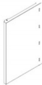
S8 (x1) ASSEMBLAGE PANNEAU LATÉRAL D'ARMOIRE RÉFRIGÉRATEUR R - A4M03598 33 3/8"x23 3/8"x1 15/16" (50x594x848.20)
