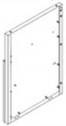
S7 (x1) ASSEMBLAGE PANNEAU LATÉRAL D'ARMOIRE RÉFRIGÉRATEUR L - A4M03597 33 7/16"x23 3/8"x2 1/16" (53x594x849.7)
