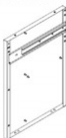
S11 (x1) ASSEMBLAGE DE PANNEAU LATÉRAL - A4M03614 33 3/8"x23 3/8"x1 15/16" (49.2x594x848.2)
