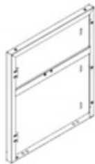
S1 (x1) ASSEMBLAGE DE PANNEAUX LATÉRAUX POUR ARMOIRE DE FOUR À PIZZA - A4M03540 26 9/16"x23 3/8"x1 3/8" (35x594x675)
