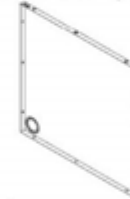
G3 ASSEMBLAGE DU PANNEAU ARRIÈRE DU MEUBLE ÉVIER - A4M03564 (x1) 34 5/16"x33 3/8"x1 3/16" (30x847.2x872)
