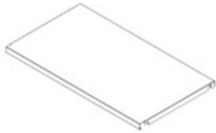
L4 ASSEMBLAGE D'ÉTAGÈRES - A4M03644 (x2) 27 3/4"x15 7/16"x1" (25x392.2x705)
