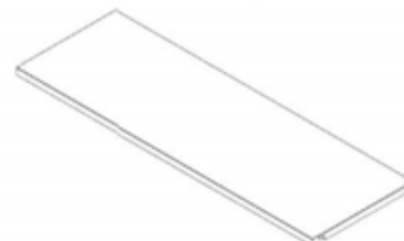
L3 ASSEMBLAGE ÉTAGÈRE M - A4M03645 (x1) 45 7/8"x15 7/16"x1" (25x392.2x1166)
