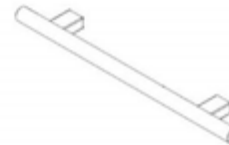
H2 POIGNÉE EN ACIER INOXYDABLE - A4M03024 (x12) 5/8"x1 9/16"x11 13/16" (16x40x300)
