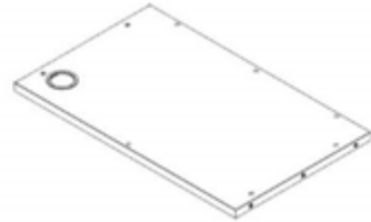
T2 ASSEMBLAGE DE PLATEAU DE GRIL - A4M03057 (x1) 1 1/4"x23 3/8"x38 3/16" (32x594x970)
