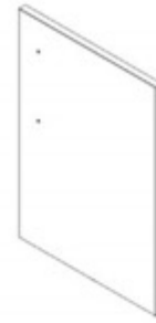
D2 ASSEMBLAGE DE PORTE D'ARMOIRE DE FOUR À PIZZA R - A4M03555 (x1) 28 7/16"x19 5/8"x15/16" (24x498x722.5)
