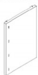
S10 (x1) ASSEMBLAGE DE PANNEAU LATÉRAL - A4M03613 33 3/8"x23 3/8"x1 15/16" (50x594x848.2)
