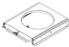
A13 ASSEMBLAGE SUPPORT DE RÉSERVOIR DE GAZ - A4M03047 (x2) 1 15/16"x12 7/8"x14 3/4" (49x327x374)
