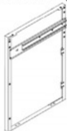
S9 (x1) ASSEMBLAGE DE PANNEAU LATÉRAL - A4M03638 33 3/8"x23 3/8"x1 15/16" (50x594x848.2)
