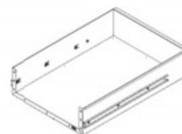
D12 ASSEMBLAGE DE CORPS DE TIROIR - A4M03621 (x2) 22 1/4"x15 13/16"x4 15/16" (126x402x565)
