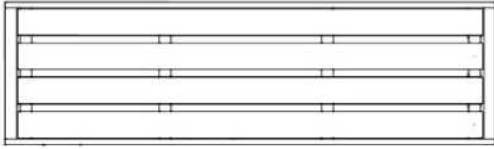
TB02 TABLE ASSEMBLY - A4M05034 (x1) 65 1/16"x18 7/8"x1 9/16" (40x479x1652)
