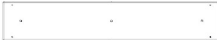
AD01 PLANCHE DE L'ARMOIRE ÉLECTRIQUE - W4L20755 (x1) 15/16"x4"x22 1/16" (24x102x560)
