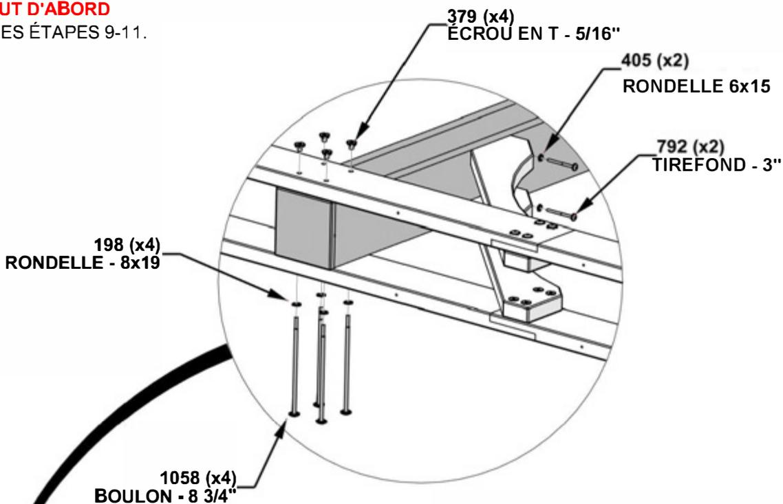
**ASSEMBLER COMME INDIQUÉ EN UTILISANT LES TROUS PILOTES PRÉ-PERCÉS DANS LE POTEAU.**
