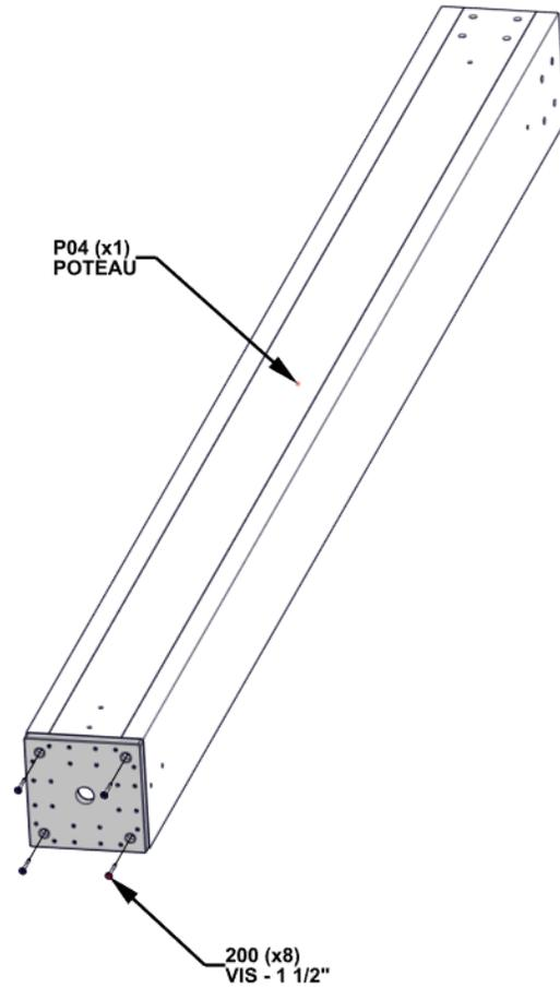
**ALIGNER LE PIED DE POTEAU ET PERCER LES TROUS PILOTES DE 1/8" POUR LA FIXATION DU MATÉRIEL.**
