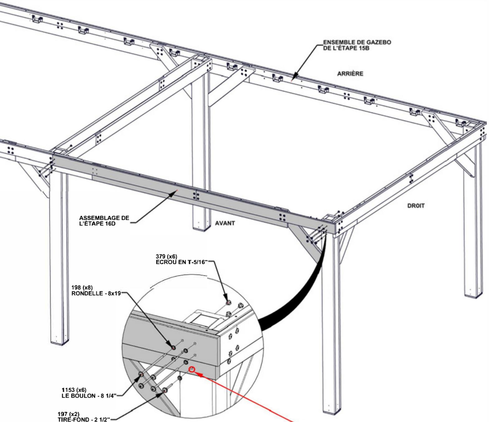
**LA VIS DE DÉCALAGE SE GLISSERA DANS LE TROU INFÉRIEUR**
