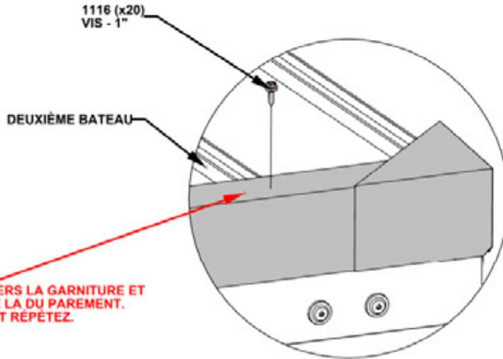
**FIXER CETTE VIS À TRAVERS LA GARNITURE ET DANS LA 2E NERVURE DE LA DU PAREMENT. SAUTER UNE NERVURE ET RÉPÉTEZ.**
