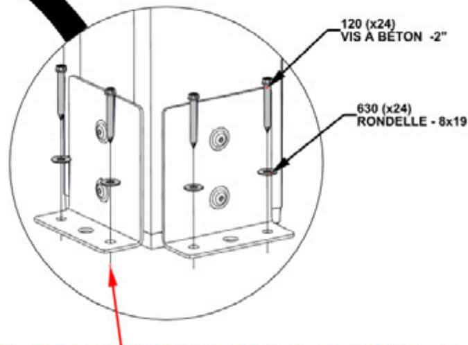
**TROUS DE PRÉ-PERÇAGE POUR ANCRAGES EN BÉTON À L'AIDE D'UN FORET EN BÉTON DE 3/16" [5 mm].**
