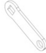
F04 LINKAGE STRAP - A4M02225 (x1) 1/8"x13/16"x2 5/8" (3x20x66)
