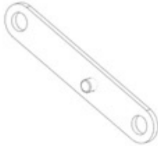
F03 LINKAGE STRAP - A4M02229 (x1) 1/2"x11/16"x3 13/16" (13x17x97)
