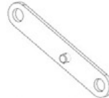
F03 LINKAGE STRAP - A4M02229 (x1) 1/2"x11/16"x3 13/16" (13x17x97)
