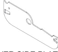
L03 LOUVER SIDE PLATE - A4M02334 (x39) 1/16"x2 3/16"x6 9/16" (2x55x167)
