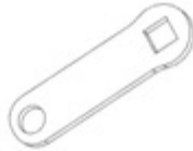
F04 LINKAGE STRAP - A4M02225 (x1) 1/8"x13/16"x2 5/8" (3x20x66)
