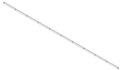
F02 LOUVER TIE STRAP - A4M02860 (x4) 1/8"x13/16"x68 1/16" (3x20x1730)
