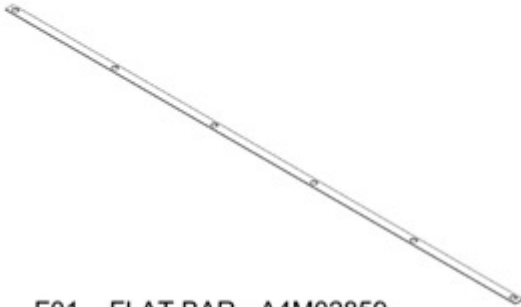
F01 FLAT BAR - A4M02859 (x4) 1/16"x1"x65 7/8" (2x25x1673)
