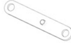
F03 LINKAGE STRAP - A4M02229 (x1) 1/2"x11/16"x3 13/16" (13x17x97)
