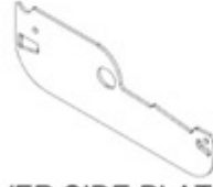
L03 LOUVER SIDE PLATE - A4M02334 (x39) 1/16"x2 3/16"x6 9/16" (2x55x167)
