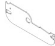
L03 LOUVER SIDE PLATE - A4M02334 (x38) 1/16"x2 3/16"x6 9/16" (2x55x167)
