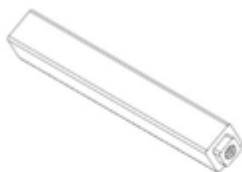
L02 PLAQUE LATÉRALE D'ENTRAÎNEMENT DU VOILET -A4M02134 (x1) 1/16"x2 3/16"x6 9/16" (2x55x167)
