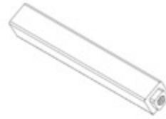
F05 PORTE-CLÉS - A4M02226 (x1) 1/2"x1/2"x3 3/4" (13x13x95)
