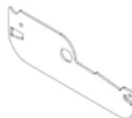
L03 PLAQUE LATÉRALE A PERSIENNES -A4M02334 (x39) 1/16 "x2 3/16" x6 9/16 "(2x55x167)
