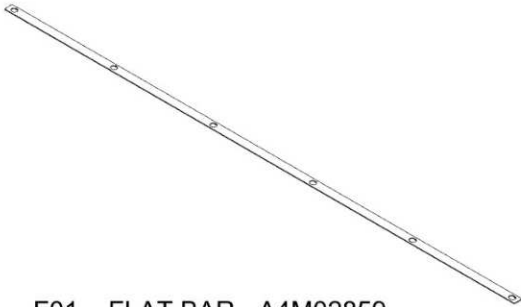
F01 FLAT BAR - A4M02859 (x4) 1/16"x1"x65 7/8" (2x25x1673)
