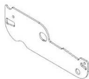
L02 PLAQUE LATÉRALE D'ENTRAÎNEMENT DU VOILET -A4M04139 (x1) 1/16"x2 3/16"x6 9/16" (2x55x167)
