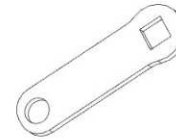
F04 - SANGLE DE LIAISON -A4M02225 (x1) 1/8"x13/16"x2 5/8" (3x20x66)
