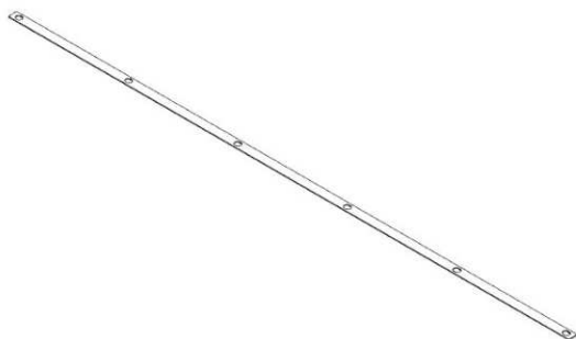
F01 BARRE PLATE -A4M02859 (x4) 1/16"x1"x65 7/8" (2x25x1673)
