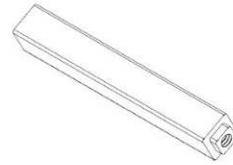
F05 PORTE-CLÉS - A4M02226 (x1) 1/2"x1/2"x3 3/4" (13x13x95)
