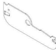
L03 PLACA LATERAL DE LAS PERSIANAS - (x39) A4M04138 1/16"x2 3/16"x6 9/16" (2x55x167)
