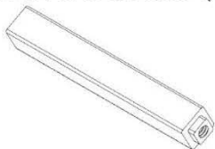
L02 PLACA LATERAL DE ACCIONAMIENTO DE LA (x1) PERSIANA- A4M04139 1/16"x2 3/16"x6 9/16" (2x55x167)
