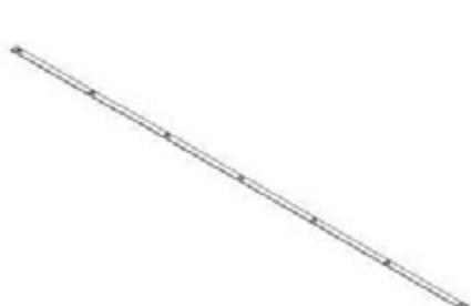
F01 FLAT BAR - A4M02129 (x1) 1/16"x1"x79 5/16" (2x25x2015)
