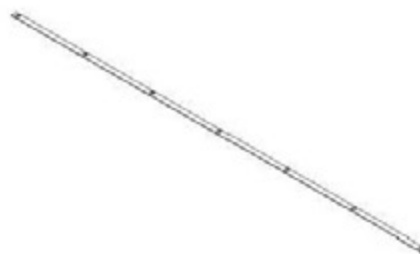
F01 FLAT BAR - A4M02129 (x4) 1/16"x1"x79 5/16" (2x25x2015)
