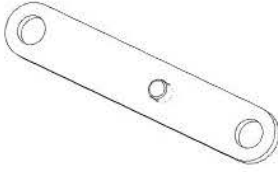
F03 LINKAGE STRAP - A4M02229 (x1) 1/8"x11/16"x3 13/16" (3x17x97)
