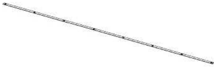
F01 FLAT BAR - A4M02572 (x1) 1/16"x1"x92 13/16" (2x25x2357)
