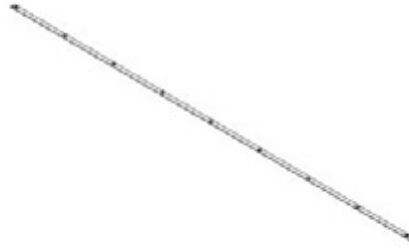
F01 FLAT BAR - A4M02585 (x4) 1/16"x1"x110 3/4" (2x25x2813)
