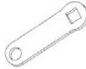
F04 LINKAGE STRAP - A4M02225 (x2) 1/8"x13/16"x2 5/8" (3x20x66)
