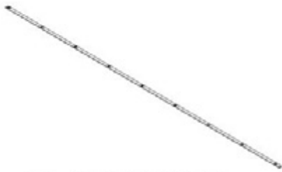
F01 FLAT BAR - A4M02585 (x1) 1/16"x1"x110 3/4" (2x25x2813)
