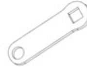
F04 LINKAGE STRAP - A4M02225 (x1) 1/8"x13/16"x2 5/8" (3x20x66)
