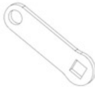
F04 LINKAGE STRAP - A4M02225 (x1) 1/8"x13/16"x2 5/8" (3x20x66)
