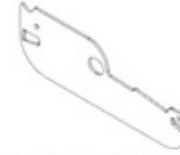
L03 LOUVER SIDE PLATE - A4M04138 (x58) 1/16"x2 3/16"x6 9/16" (2x55x167)
