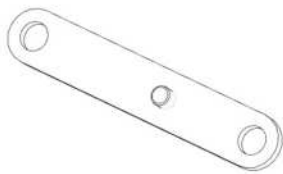
F03 LINKAGE STRAP - A4M02229 (x1) 1/2"x11/16"x3 13/16" (13x17x97)
