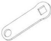
F04 LINKAGE STRAP - A4M02225 (x1) 1/8"x13/16"x2 5/8" (3x20x66)
