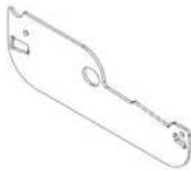
L03 LOUVER SIDE PLATE - A4M04138 (x58) 1/16"x2 3/16"x6 9/16" (2x55x167)
