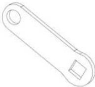
F04 LINKAGE STRAP - A4M02225 (x1) 1/8"x13/16"x2 5/8" (3x20x66)
