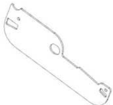
L03 LOUVER SIDE PLATE - A4M04138 (x59) 1/16"x2 3/16"x6 9/16" (2x55x167)
