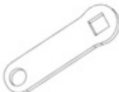
F04 LINKAGE STRAP - A4M02225 (x1) 1/8"x13/16"x2 5/8" (3x20x66)
