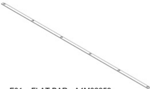
F01 FLAT BAR - A4M02859 (x4) 1/16"x1"x65 7/8" (2x25x1673)
