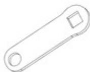
F04 LINKAGE STRAP - A4M02225 (x1) 1/8"x13/16"x2 5/8" (3x20x66)
