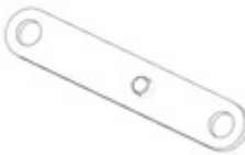
F03 LINKAGE STRAP - A4M02229 (x1) 1/2"x11/16"x3 13/16" (13x17x97)
