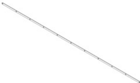
F02 LOUVER TIE STRAP - A4M02860 (x4) 1/8"x13/16"x68 1/16" (3x20x1730)
