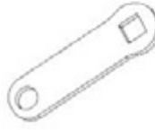
F04 LINKAGE STRAP - A4M02225 (x1) 1/8"x13/16"x2 5/8" (3x20x66)
