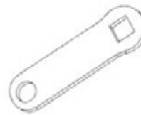
F04 LINKAGE STRAP - A4M02225 (x1) 1/8"x13/16"x2 5/8" (3x20x66)
