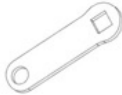
F04 LINKAGE STRAP - A4M02225 (x1) 1/8"x13/16"x2 5/8" (3x20x66)
