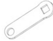
F04 LINKAGE STRAP - A4M02225 (x1) 1/8"x13/16"x2 5/8" (3x20x66)
