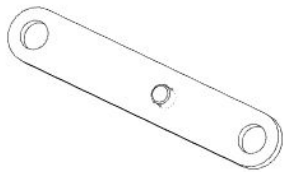
F03 LINKAGE STRAP - A4M02229 (x1) 1/2"x11/16"x3 13/16" (13x17x97)
