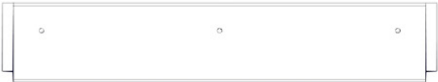
E10 FAN FRAME - W4L20178 (x1) 1 7/16"x3 3/8"x18 3/8" (36x86x467)
