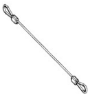
DC01 DOOR CABLE - A4M02504 (x2) 1/8"x9 7/16" (2.5x240)
