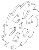
S02 SPROCKET - A4M02147 (x1) 3/16"x4 11/16"x4 11/16" (4x119x119)
