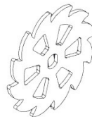
S02 SPROCKET - A4M02147 (x1) 3/16"x4 11/16"x4 11/16" (4x119x119)
