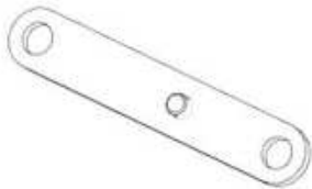
F03 LINKAGE STRAP - A4M02229 (x4) 1/2"x11/16"x3 13/16" (13x17x97)
