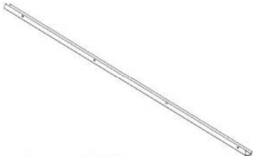
G02 GUTTER - A4M05828 (x2) 1 9/16"x2 11/16"x84 3/16" (40x69x2138)
