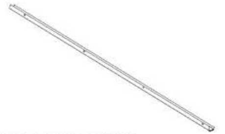
G02 GUTTER - A4M05828 (x1) 1 9/16"x2 11/16"x84 3/16" (40x69x2138)
