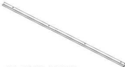
G01 GUTTER - A4M05827 (x2) 1 9/16"x2 11/16"x84 1/4" (40x69x2140)
