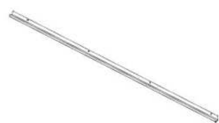
G01 GUTTER - A4M05827 (x1) 1 9/16"x2 11/16"x84 1/4" (40x69x2140)
