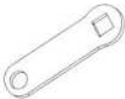
F04 LINKAGE STRAP - A4M02225 (x4) 1/8"x13/16"x2 5/8" (3x20x66)
