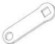
F04 LINKAGE STRAP - A4M02225 (x4) 1/8"x13/16"x2 5/8" (3x20x66)
