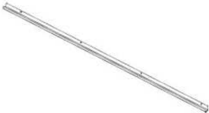
G01 GUTTER - A4M05827 (x1) 1 9/16"x2 11/16"x84 1/4" (40x69x2140)
