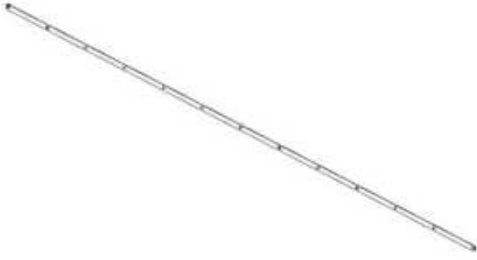
F02 LOUVER TIE STRAP - A4M02130 (x8) 1/8"x13/16"x81 9/16" (3x20x2072)
