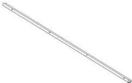
G02 GUTTER - A4M05828 (x1) 1 9/16"x2 11/16"x84 3/16" (40x69x2138)
