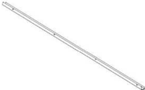
G02 GUTTER - A4M05828 (x2) 1 9/16"x2 11/16"x84 3/16" (40x69x2138)
