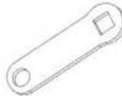
F04 LINKAGE STRAP - A4M02225 (x4) 1/8"x13/16"x2 5/8" (3x20x66)
