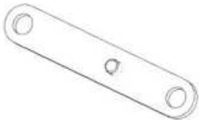
F03 LINKAGE STRAP - A4M02229-01 (x4) 1/8"x11/16"x3 13/16" (3x17x97)
