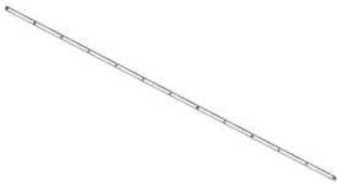
F02 LOUVER TIE STRAP - A4M02130 (x1) 1/8"x13/16"x81 9/16" (3x20x2072)
