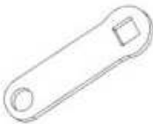
F04 LINKAGE STRAP - A4M02225 (x4) 1/8"x13/16"x2 5/8" (3x20x66)
