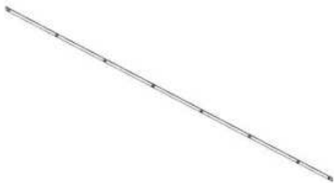
F01 FLAT BAR - A4M05834 (x8) 1/16"x1"x88 1/4" (2x25x2241.00)
