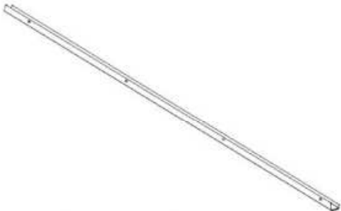
G02 GUTTER - A4M05828 (x2) 1 9/16"x2 11/16"x84 3/16" (40x69x2138)
