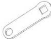
F04 LINKAGE STRAP - A4M02225 (x4) 1/8"x13/16"x2 5/8" (3x20x66)
