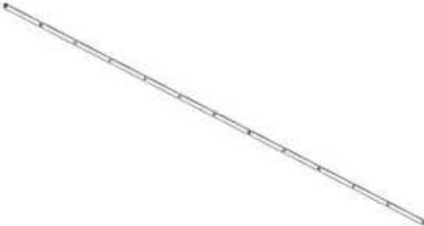
F02 LOUVER TIE STRAP - A4M02130 (x8) 1/8"x13/16"x81 9/16" (3x20x2072)
