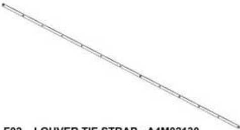
F02 LOUVER TIE STRAP - A4M02130 (x2) 1/8"x13/16"x81 9/16" (3x20x2072)
