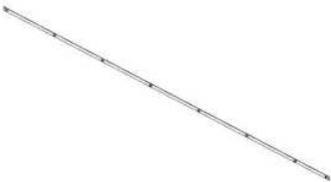
F01 FLAT BAR - A4M05834 (x8) 1/16"x1"x88 1/4" (2x25x2241.00)
