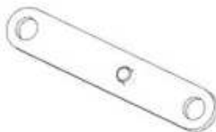
F03 LINKAGE STRAP - A4M02229 (x4) 1/2"x11/16"x3 13/16" (13x17x97)
