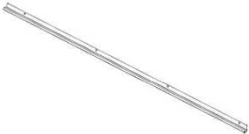
G01 GUTTER - A4M05827 (x2) 1 9/16"x2 11/16"x84 1/4" (40x69x2140)
