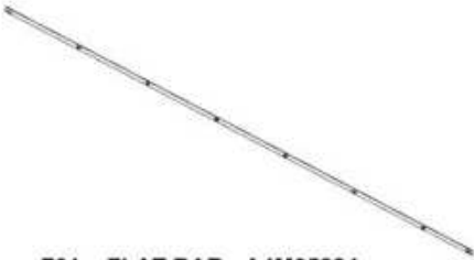
F01 FLAT BAR - A4M05834 (x1) 1/16"x1"x88 1/4" (2x25x2241.00)
