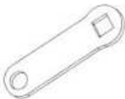
F04 LINKAGE STRAP - A4M02225 (x4) 1/8"x13/16"x2 5/8" (3x20x66)
