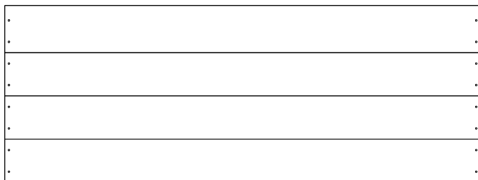
RP01 PANNEAU DE TOIT - W2A05017 (x2) 7/8"x20 11/16"x55 9/16" (23x526x1411)
