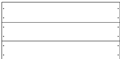
RP03 PANNEAU DE TOIT - W2A05019 (x2) 7/8"x15 5/8"x32 1/16" (23x397x815)
