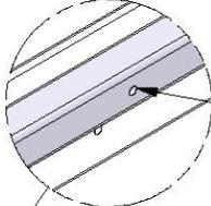
**VIS 1-14 PO - NOTEZ L'EMPLACEMENT DES TROUS DANS LES PLANCHES « S2 » ET « S3 » POUR UN ASSEMBLAGE CORRECT.**
