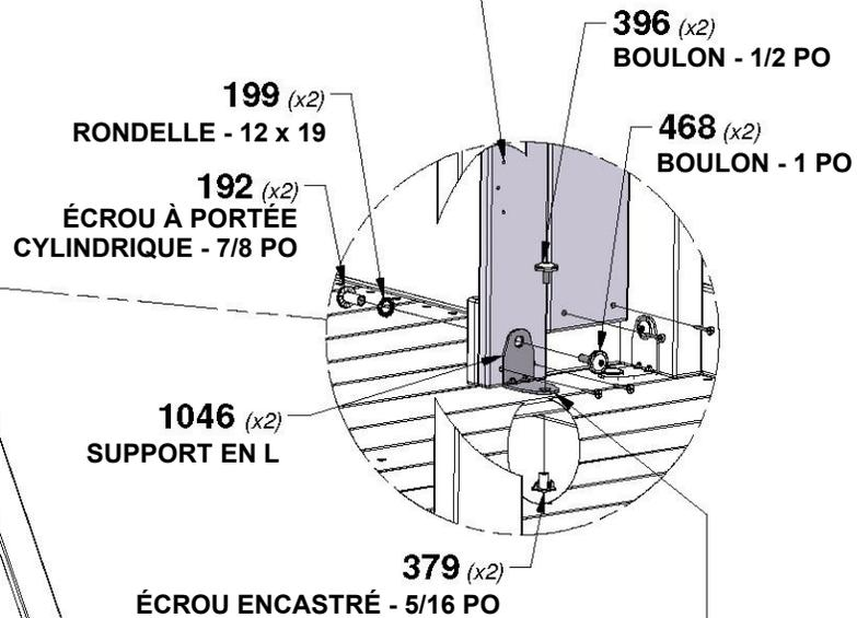
EN UTILISANT LES SUPPORTS COMME GUIDE, PERCEZ UN TROU DE 3/8 po [10 mm] À TRAVERS LE PLANCHER POUR LA QUINCAILLERIE.
