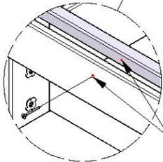
**ALIGNER LES AVANT-TROUS DES PLANCHES AVEC LES TROUS TRAVERSANTS DES PLANCHES CORRESPONDANTES.**
