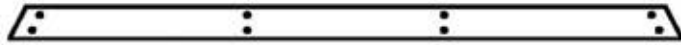
H3 TABLA DE APOYO DE LA BARRA TREPADORA - W4L14545 (x1) 1" x 3 3/8" x 70 3/8" (24 x 86 x 1786)
