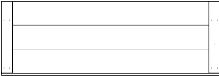
RP1 | PANNEAU DE TOIT - W104015 (x1) | 1 5/8 po x 15 5/8 po x 46 po (42 x 396 x 1168)
