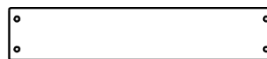
M78 | CALE CENTRALE DE TOBOGGAN - W100545 (x2) 5/8 po x 3 3/8 po x 17 1/4 po (16 x 86 x 438)
