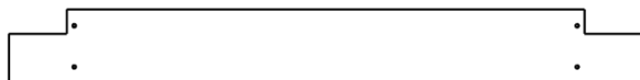
Q1 | PLANCHE DE SIÈGE - W104011 (x1) 1 po x 4 3/8 po x 37 1/2 po (24 x 112 x 952)
