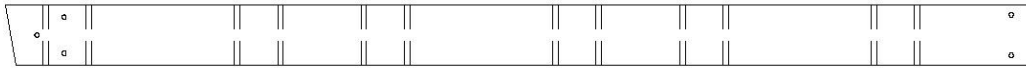
A50 | POUTRE DE BALANÇOIRE - W4L15998 (x1) | 3 3/8 po x 5 1/4 po x 89 1/2 po (86 x 134 x 2274)
