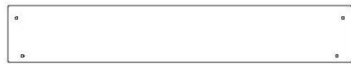
L03 | LISSE DE PLANCHER DU NID-DE-PIE - W4L15906 (2) | 5/8 po x 4 3/8 po x 27 po (16 x 112 x 686)
