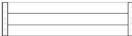
RP6 | PANNEAU DE TOIT - W2A02627 (2) | 1 5/8 po x 15 5/8 po x 59 po (42 x 396 x 1499)
