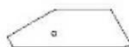
E8 | CALE DE PLATEFORME DU NID-DE-PIE - W4L15902 (2) | 1 7/16 po x 3 3/8 po x 10 7/8 po (36 x 86 x 276)
