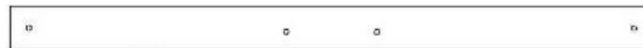
H14 | SUPPORT DE POUTRE DE BALANÇOIRE - W4L15895 (1) 1 po x 3 3/8 po x 50 1/4 po (24 x 86 x 1277)
