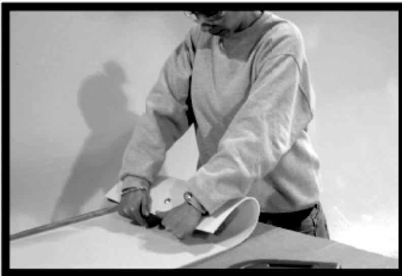
UTILISEZ LE RENFORT DE LA GLISSOIRE «M77» COMME GABARIT POUR LES EMPLACEMENTS À PRÉPERCER SOUS L'ASSISE DE LA GLISSOIRE. ASSUREZ-VOUS DE PLACER LE RENFORT DE LA GLISSOIRE VERT LE HAUT À 1/4 PO DU BORD INFÉRIEUR AVANT DE PRÉPERCER LES TROUS.
