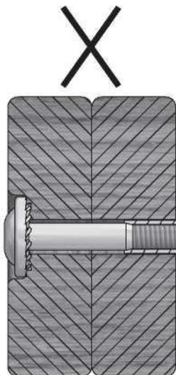
Si vous pouvez voir le filetage et que votre boulon dépasse de l'écrou encastré, il est possible que vous ayez trop serré le boulon ou utilisé du matériel incorrect. Si vous avez trop serré, retirez le boulon et ajoutez des rondelles pour éliminer la saillie.
