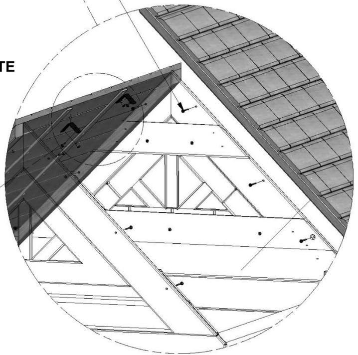
REMARQUE : SUPPORTS EN L MONTÉS SUR LES TASSEaux DE TOIT
