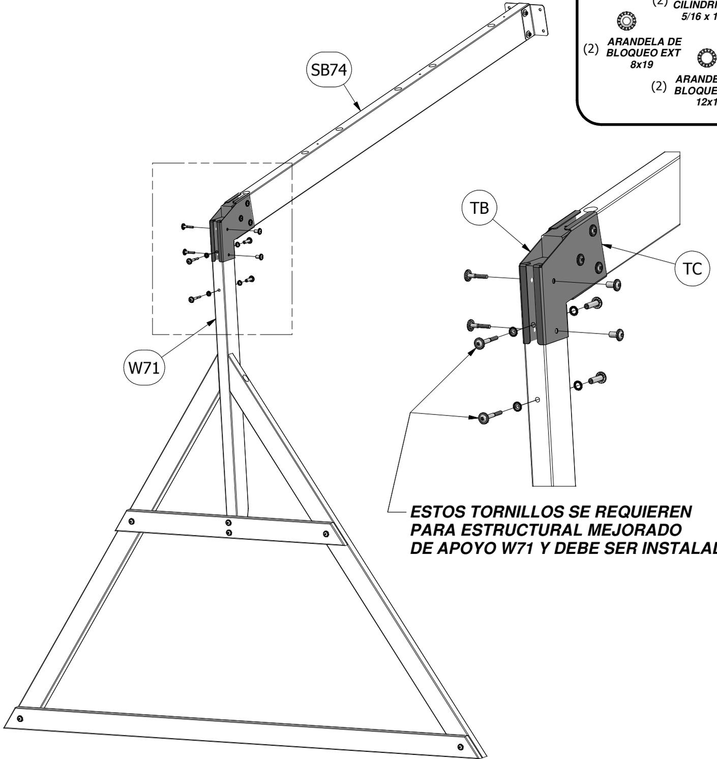
**ESTOS TORNILLOS SE REQUIEREN PARA ESTRUCTURAL MEJORADO DE APOYO W71 Y DEBE SER INSTALADO.**
