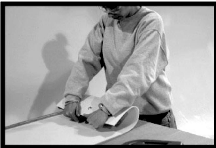
**USO EL REFUERZO LA RESBALADILLA 'M70' COMO PLANTILLA. PARA PERFORAR EL AGUJERO INFERIOR EN EL LECHO LA RESBALADILLA. COLOQUE EL REFUERZO LA RESBALADILLA A 1/2" (12 mm) HACIA ARRIBA DEL BORDE INFERIOR DEL LECHO LA RESBALADILLA ANTES DE MARCAR EL PATRÓN DEL AGUJERO. UTILICE UNA BROCA DE 3/8" (10 mm) PARA PATRÓN DEL AGUJERO.**
